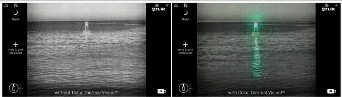
RaymarineAxiom®のみで使用可能な FLIR Color Thermal Vision は、可視カメラの詳細と熱画像をブレンドし、重要なカラー画像を重ねることで、船長がナビゲーションエイドや熱シーン内の他の船舶を明確に識別できるようにします。
